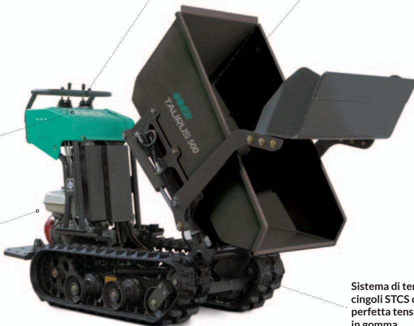
Sistema di tensionamento dei cingoli STCS che garantisce la perfetta tensione del cingolo in gomma
