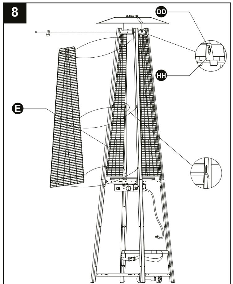
9. Fissare i tre pannelli laterali al riscaldatore utilizzando 18 viti da 3/16". Nota: Non coprire il lato anteriore dove si trova la manopola di controllo.
