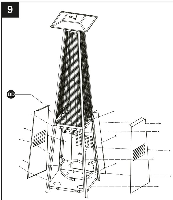
10. Installare la manopola alla vite M4X6. Appendere la catena al foro sul montaggio della scatola di controllo e inserire il gancio del pannello frontale nei fori della piastra inferiore.
